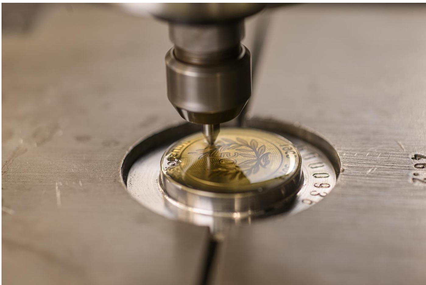
Frezado de stampilo per CNC-maŝino. Foto Pichl.
