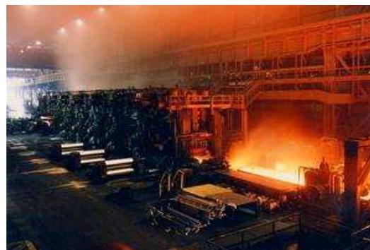
hejtado de metalaj slaboj antaŭ ol laminatado
