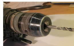
rapida ĉuko por elektra borilo (blokita mane sen ĉukboltilo)
