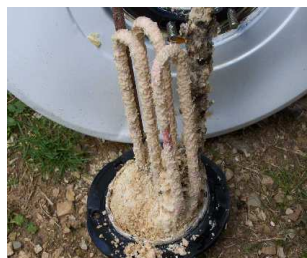
kalka deponaĵo en akvohejtilo
