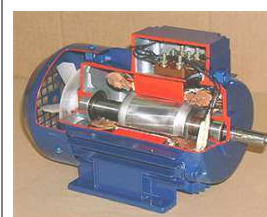
elektra kaĝrotora nesinkrona motoro
