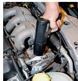
stroboskopa lampo por mezuri rotacian rapidon en rivolunombro je minuto
