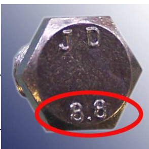
stampo sur ŝraŭbkapo : cedlimo = 8 (80 kg/mm 2 ) elastolimo = 80% (64 kg/mm 2 )
