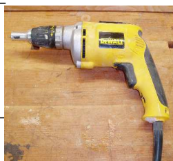
ŝraŭbmaŝino per ŝtopbuteo kaj nutrokonduktilo (por fiksi paneloj)
