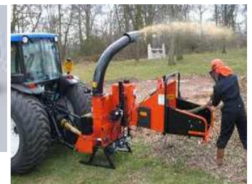
traktorŝafto de traktoro (tie kuplita kun lignopistilo)
