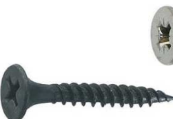
krucŝraŭbo por gipspaneloj (per ŝraŭbkapo Philips por bone teni sur ŝraŭbmaŝino, akra pinto por piki metalaj reloj kaj rondforma subkapo por ne rompi la panelojn)
