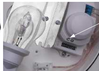
lineo de ŝaltiletoj por parametri hiperfrekvenca movdetektilo de lampo
