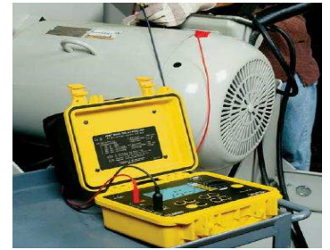
kontroli izolrezistancon de motoro per megometro
