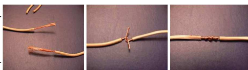
splisaĵo pri du flekseblaj elektrodratoj
