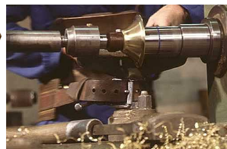
mandreno por retropuŝi latunan ladon sur tornilo
