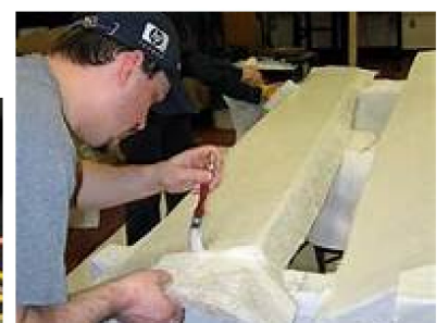
ŝmirado de vitra fibro per rezino
