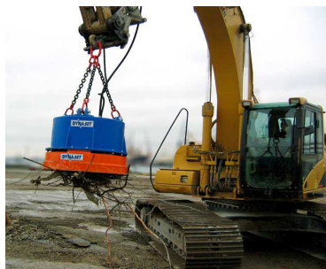
elektromagneto por preni feraĵoj
