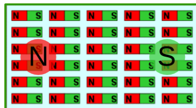
Fig. 88: elementaj magnetoj ordigitaj per ekstera magneto
